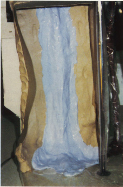
Abb. 2: Die stehende Form erfordert einen pastös eingestellten Silikon.
