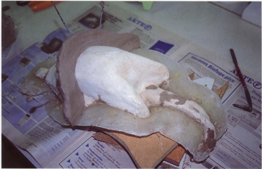
Abb. 1: Herstellung der 4-teiligen Negativform für den Körper mit Tontrennkanten.
