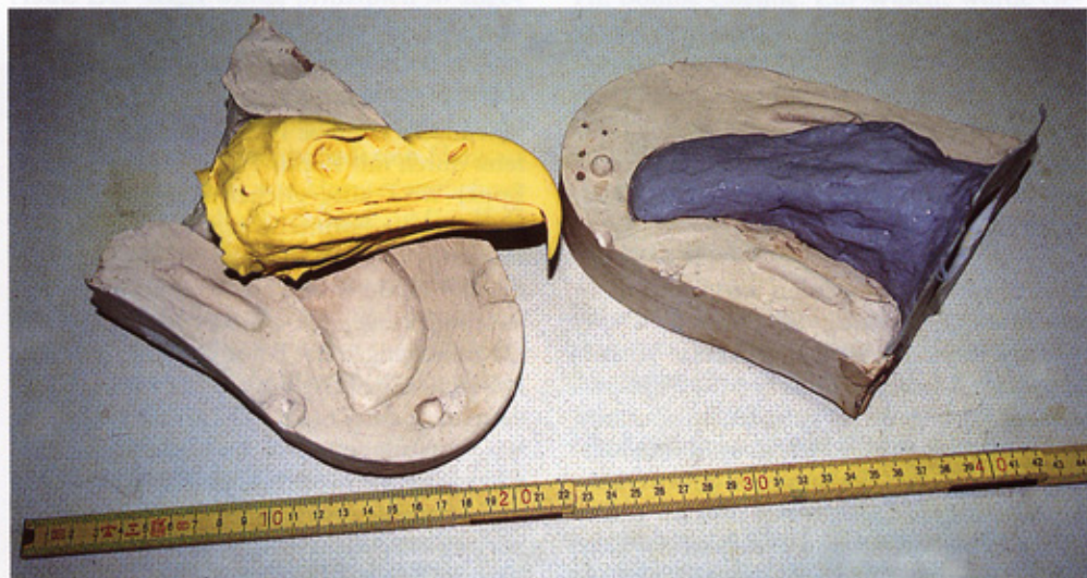
Abb. 3: Der künstliche Kopf: Negativformteile und das Epoxidpositiv.
